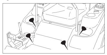
Figure 16. Control Handle Pivots & Seat Plate Pivots
